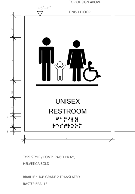
5 BATHROOM SIGNAGE SCALE: 3" = 1'-0"
